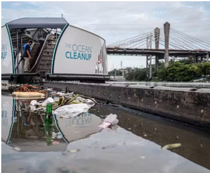
شناور خورشیدی با قابلیت فیلتر پلاستیک های خارج از آب
